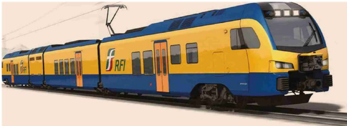
Manutenzione dei binari. Il rendering di un treno diagnostico commissionato da Rfi (Rete ferroviaria italiana)
